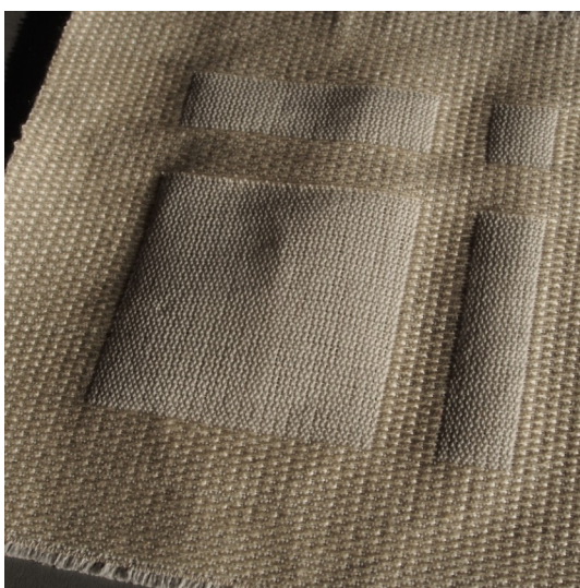
GS: Papiergarn / ficelle à papier Nm 7,5 (7500 m/kg) MS: Yakusi (50 % Yak / 50 % Seide/soie - 8000 m/kg)
