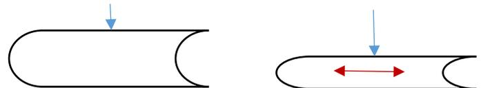
3. Reissprobe: entlang der Laufrichtung reißt das Papier gerader als in der Querrichtung
