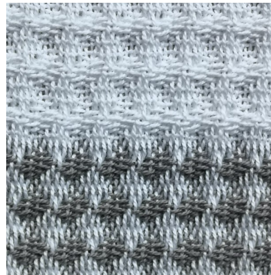
Geweberückseite zu Patrone 4b Verso du tissu pour patron 4b
