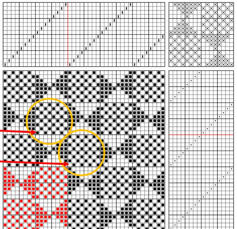
Diese beiden leinwandbindenden Flächen sind nicht gleich. Die eine fängt unten links mit einem gehobenen Kettfaden an, die andere mit einem gesenkten Kettfaden
